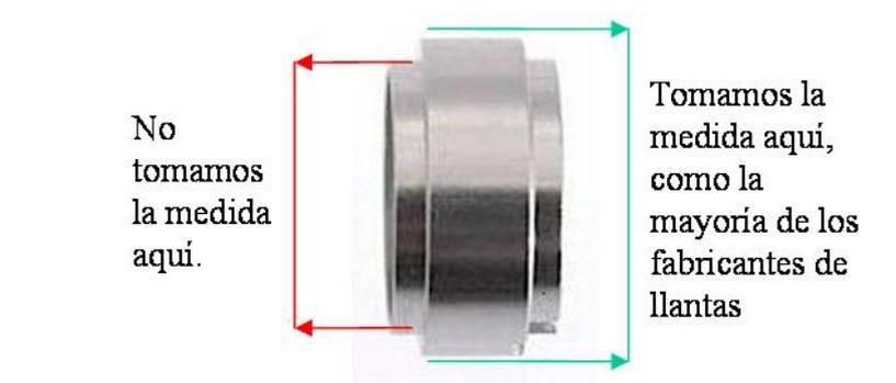
El ancho máximo de llanta será de 11mm y el mínimo 8mm.
